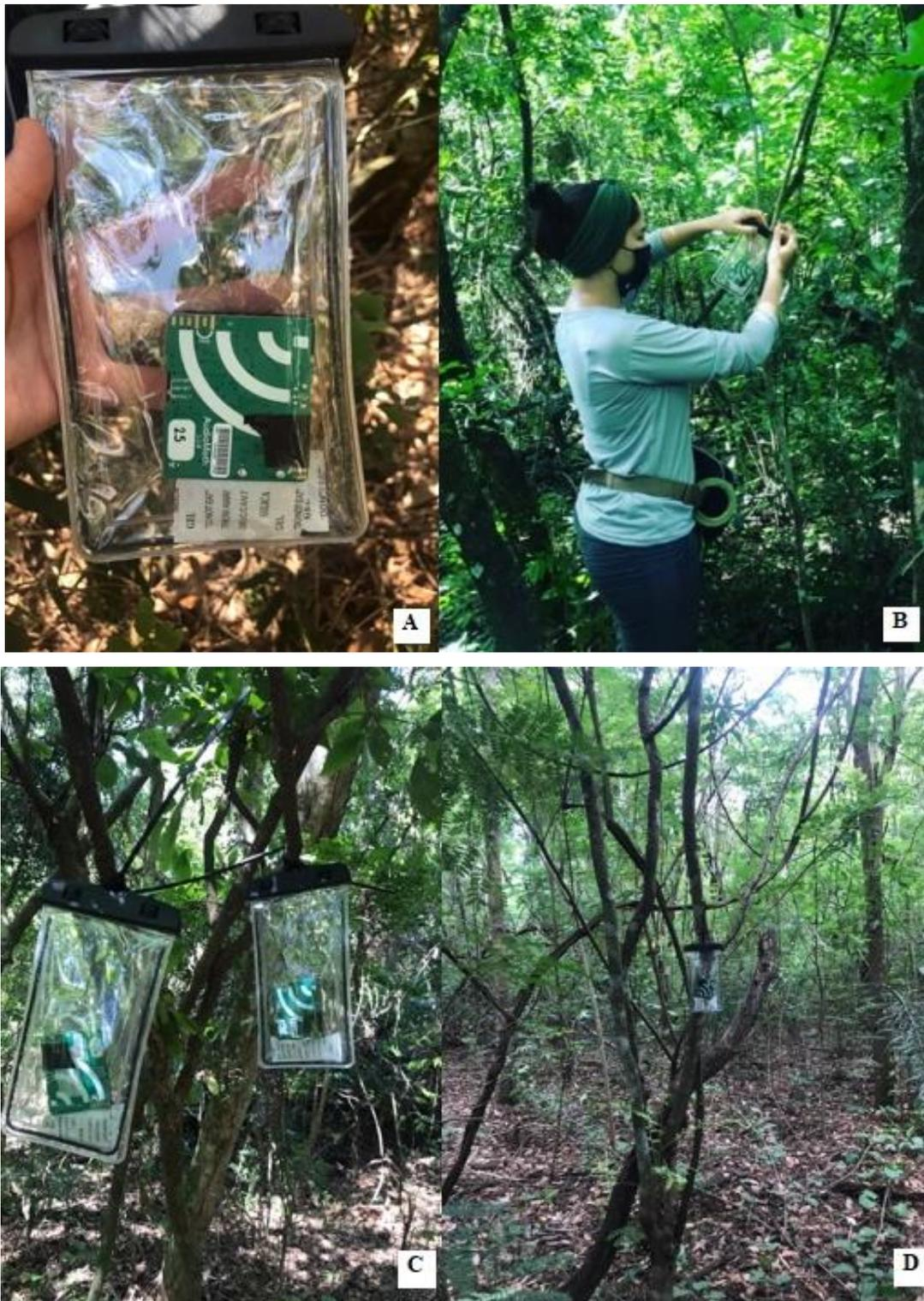
Figura 6. Instalação de gravadores portáteis Audiomoth 1.14. A) Gravador preparado para instalação no campo, com capa impermeável. B) Instalação dos gravadores em campo. C e D) Gravadores devidamente instalados.
