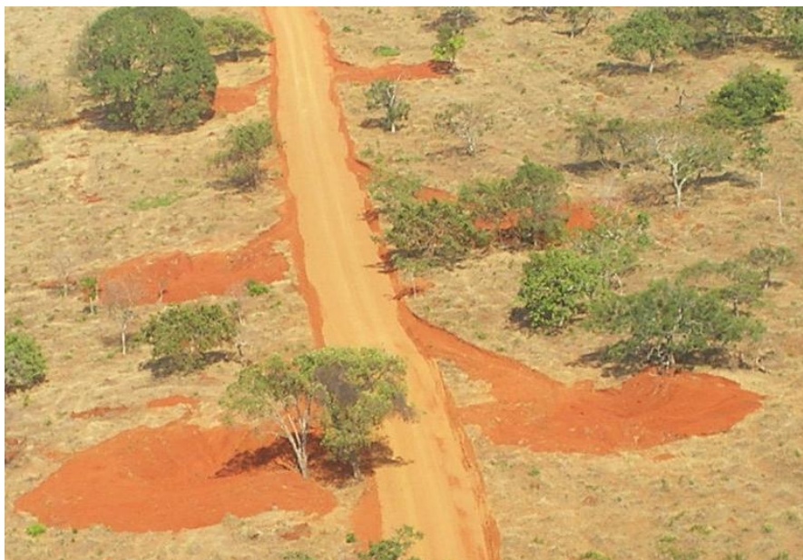
Figura 11 - Estrada não pavimentada com bacias de retenção. Fonte: Fundação Rural Mineira – MG
