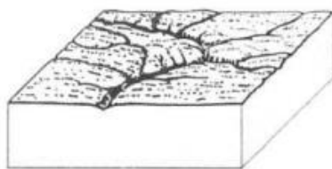
Figura 6 - Erosão em sulcos. Fonte: Hillel (1998).
