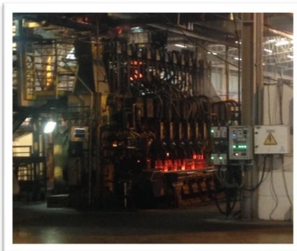
Figura 7 - Produção de garrafas na indústria Vidro Porto, pelo método prensa-sopro
