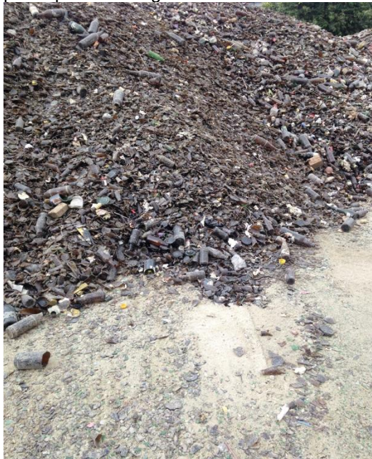
Figura 13 - Cacos triturados e resíduos de garrafas a serem utilizados como matéria-prima para reciclagem
