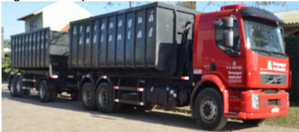
Figura 15 - Tipo de caminhão roll-on e roll-off
