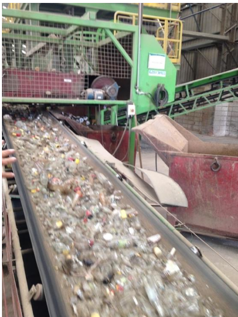
Figura 21 - Esteira para separação ótica
