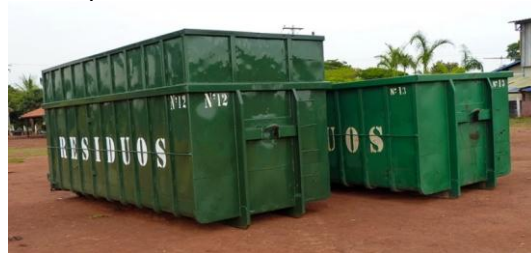
Figura 16 - Tipo de caçamba estacionária usada para coleta de cacos de vidro
