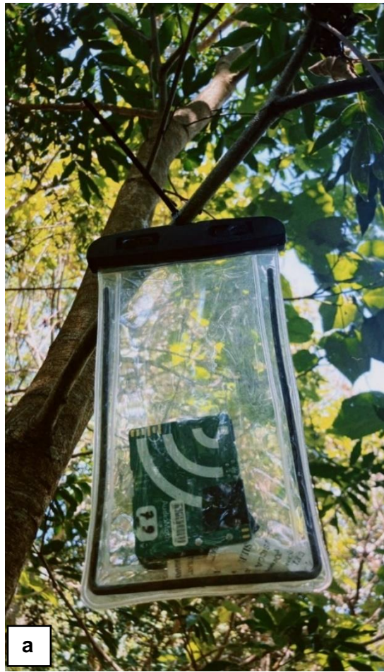
Figura 3. Gravadores autônomos Audiomoth 1.14. a) instalação dos gravadores em campo, com capas protetoras e devidamente identificados; b) disposição dos gravadores em campo.
