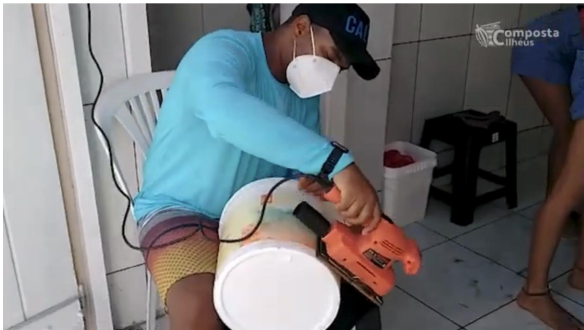
Figura 19- Voluntário Rafael Bastos utilizando lixadeira para remoção de tinta e nomes das marcas do produto Fonte: Acervo GAP, 2022
