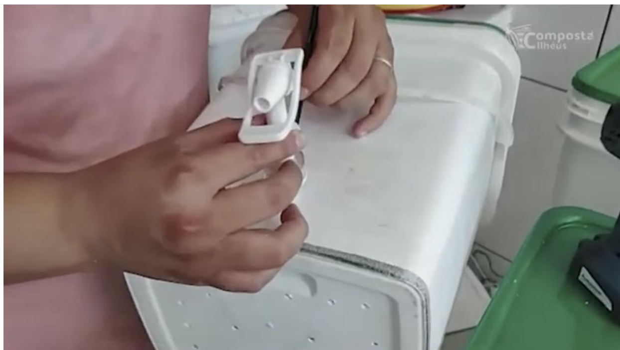
Figura 18 - Instalação da Torneira de PVC na parte inferior do terceiro balde Fonte: Acervo GAP, 2022
