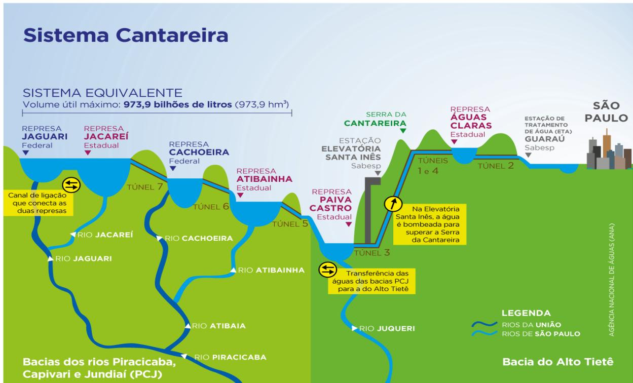
**Figura 10:** Estrutura do Sistema Cantareira. Fonte: Agência Nacional de Águas e Saneamento Básico (ANA).
