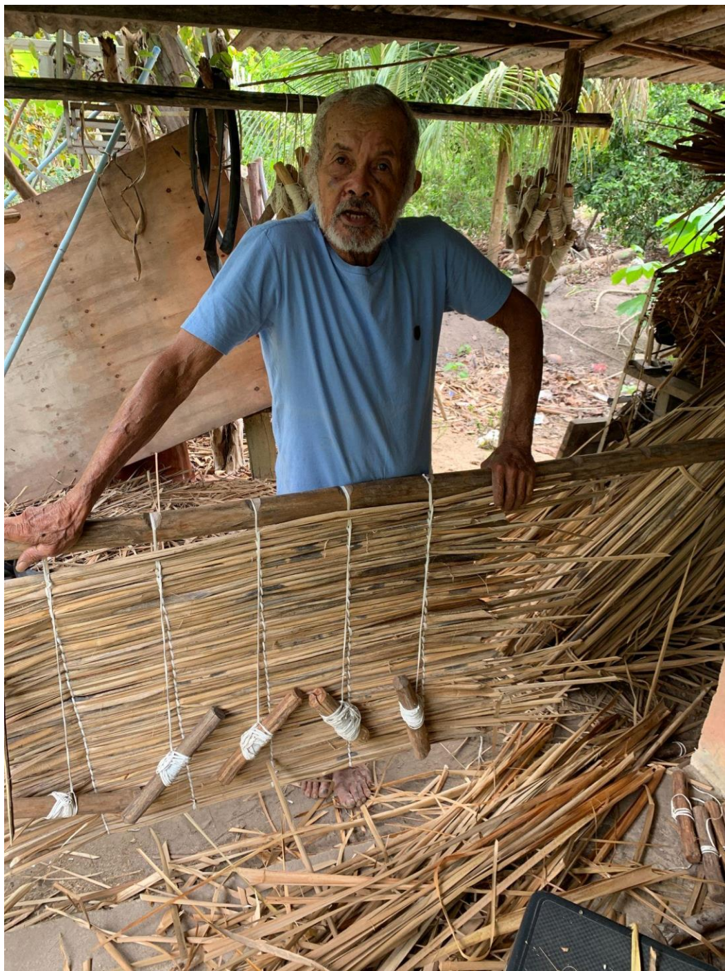
Figura 67 — Percurso Mapeador pelo Sítio Uirapuru na Comunidade Quilombola Corrego da Angélica, na foto Seu Pedro mostra sua oficina e técnica de fabricação das tradicionais esteiras de taboa.
