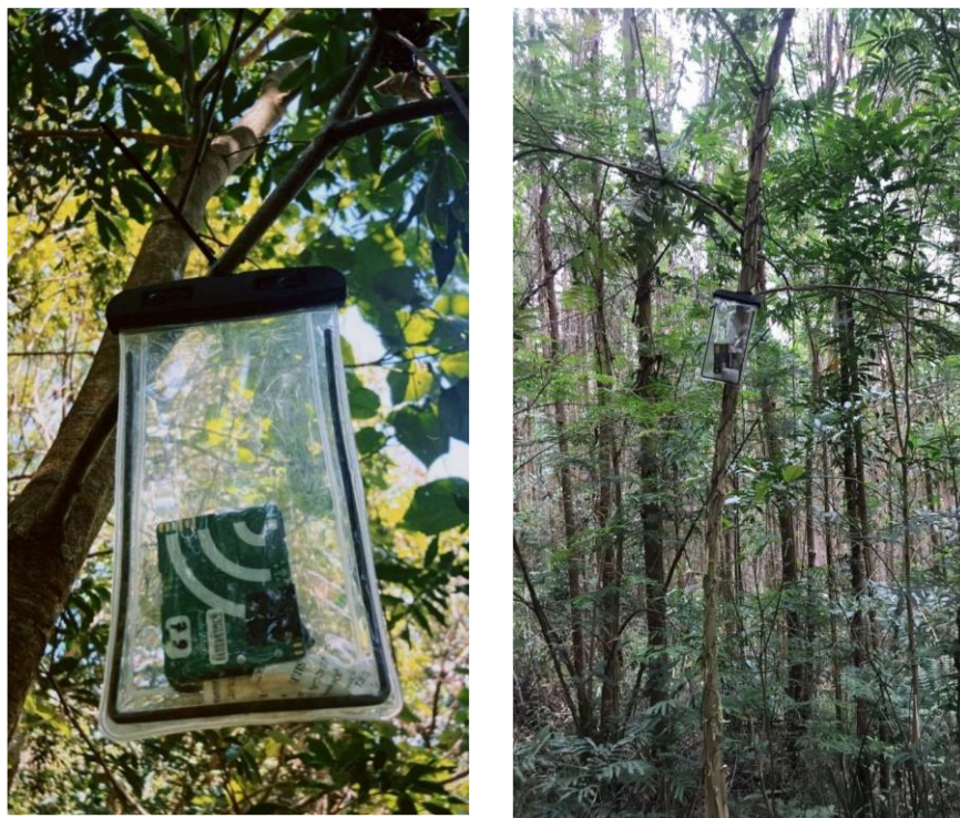
Figura 02. Gravadores autônomos Audiomoth. Instalação dos gravadores em campo, com capas protetoras e devidamente identificados (Esquerda); Disposição dos gravadores em campo (Direita).
